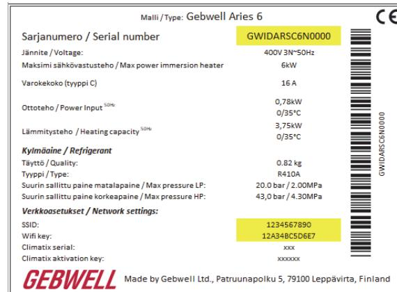
Typskylten ligger på styrcentralens täckplåt bakom frontdörren och på baksidan av Användarmanual
