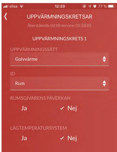
*Rumsgivarens inverkan:* välj "Ja", om det finns en rumsgivare i uppvärmningskretsen.
