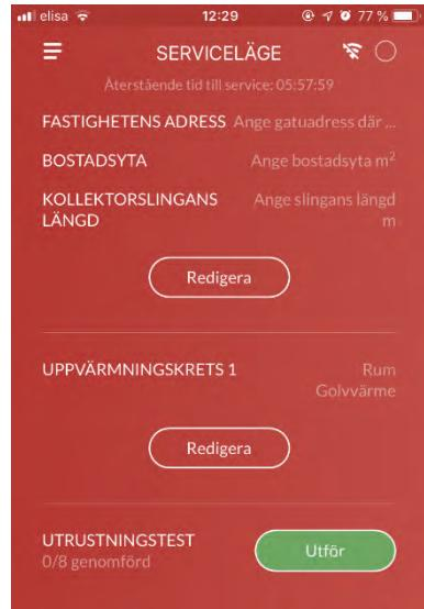
I utrustningstestet kan du slutföra avluftningen av tappvattenkretsen och avlufta laddkretsen. Detta görs lätt genom att ändra växelventilens position på elektrisk väg.
