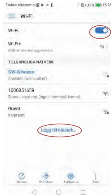
Välj *Skydd* och byt WPA/WPA2 som krypteringstyp. Ange nätverkets namn och lösenord. Informationen hittar du på typskylten (nätverkets namn: SSID och lösenordet Wifi Key), som finns på värmepumpens typskylt. Krypteringstyp enligt bilden nedan.
